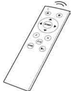
Es handelt sich um eine kabellose 2.4G-Fernbedienung, die Ihren Roboter innerhalb eines Radius von maximal 15 Metern aus jeder Richtung steuern kann.
